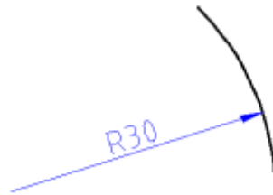
Figura 41: Esempio di quota radiale.
