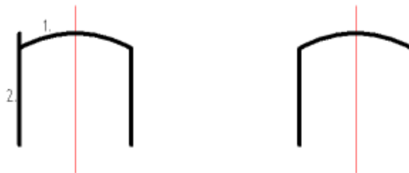
Figura 58: Con lo strumento per raccordare, la linea a sinistra può essere facilmente regolata alla giusta lunghezza per terminare all'inizio dell'arco.
