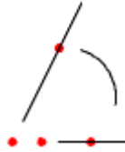
Figura 27: Lo strumento di aggancio manuale alle intersezioni vi permette di specificare le intersezioni non visibili.
